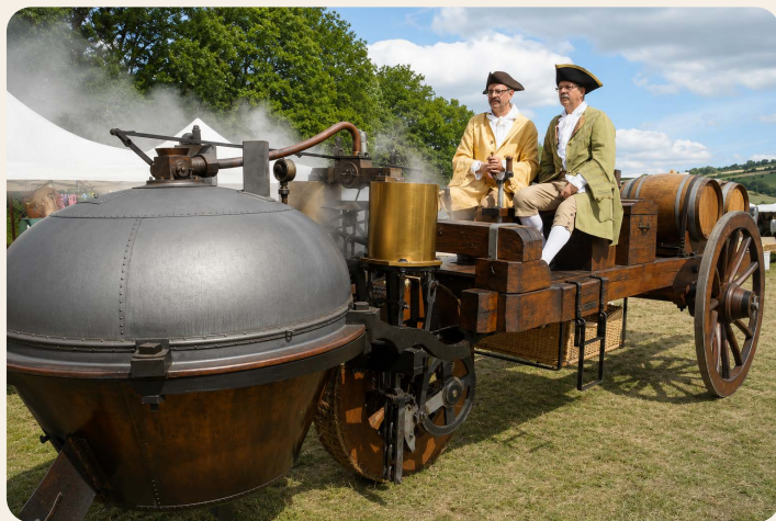
Паровая телега Кьюнью — один из первых прообразов автомобиля
